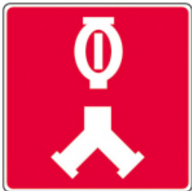
Raccords-pompiers pour le réseau de gicleurs
